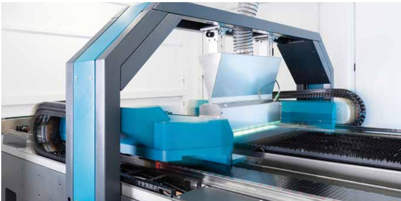
用于划分薄膜光伏电池组件导线中导体层和半导体层的激光结构处理
