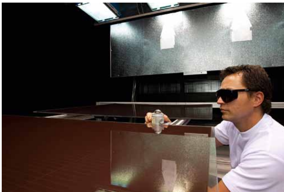
Lichtungstest: Justierung des Pyranometers | Exposure test: aligning the pyranometer
